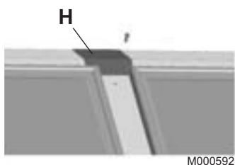
**13.** Bevestig de aansluitplaat op het bovenste afdekelement met behulp van een plaatschroef.
