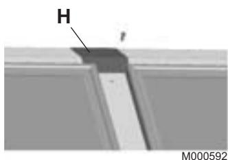
**13.** Fixer la tôle de jonction à la pièce de recouvrement supérieur à l'aide d'une vis à tête.
