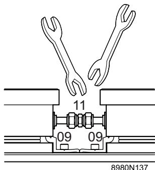
**i** Le jeu vertical de la tôle de jonction permet d'accéder aux raccordements hydrauliques et de fixer les capteurs solaires.
